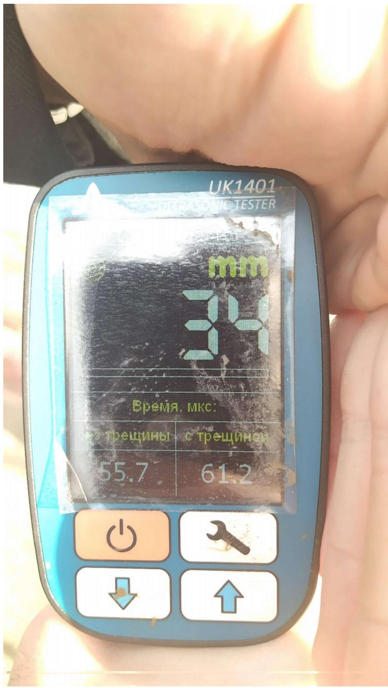
Фото 4. Измерение глубины раскрытия трещин в наружной кладке несущих стен здания по адресу: г. Москва, Ленинский проспект, д. 74.
